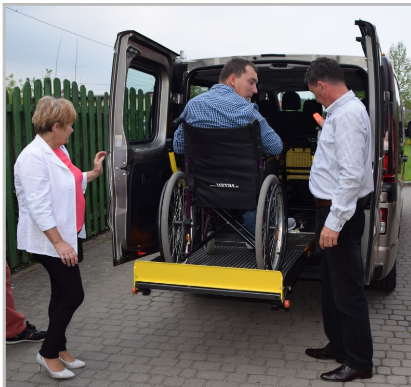
Samochód został wyposażony w windę umożliwiającą transport osób niepełnosprawnych na wózkach inwalidzkich
